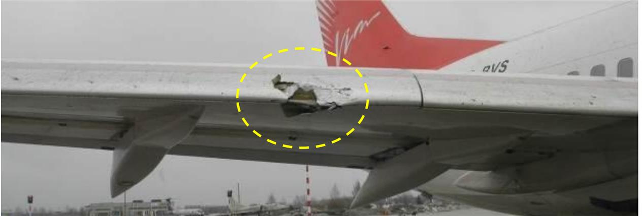
Photo 4 R/H Leading Edge Slat No 5 damages
