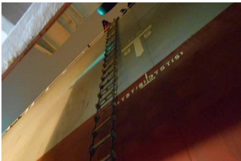
7.2.att. Loču trepes, no kurām nokrita kuģa Stahla apkalpes loceklis uz blakus esošā kuģa (bunkurētāja) klāja. Augstums ap 10 metriem, cietušais smagi traumēts.
