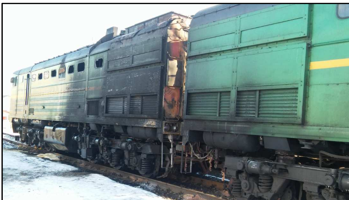
6.3. att. Lokomotīve pēc ugunsgrēka
