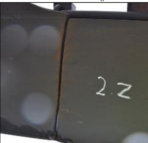
Plaisa visā sānu rāmja apakšējā horizontālā plaukta šķērs griezumā
