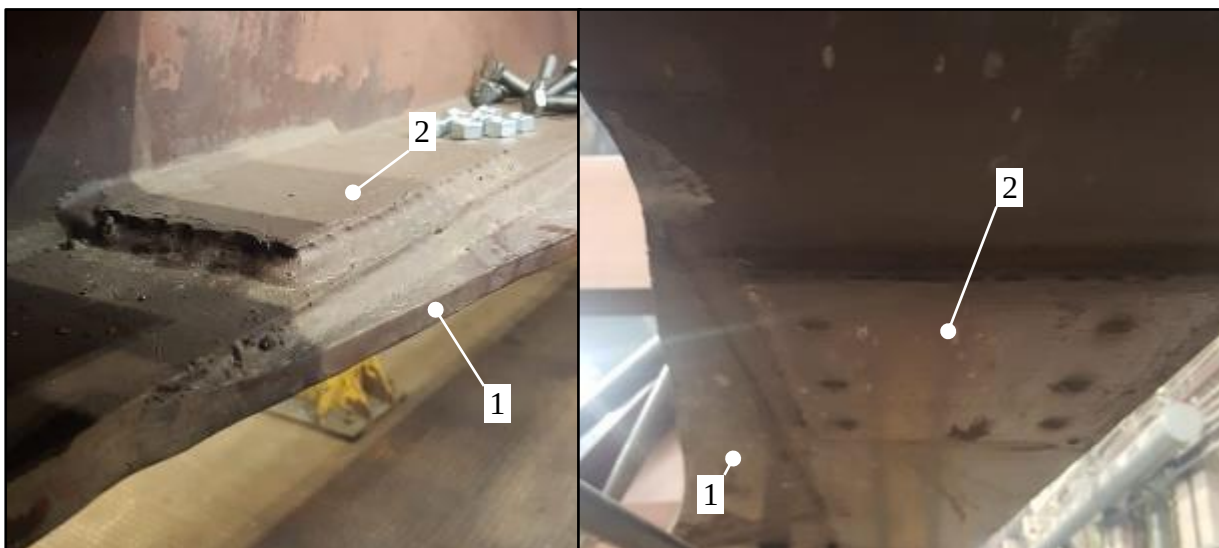
16.att. Problēmu zonā piemetinātās jaunas stūra plātnes un uzstādītās pastiprinošās uzlikas uz vagona Nr. 94962537 rāmja
