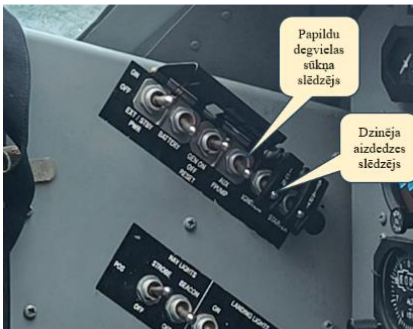
Att. 33. Slēdzēju pozīcija gaisa kuģa kabīnē pēc aviācijas nelaimes gadījuma
