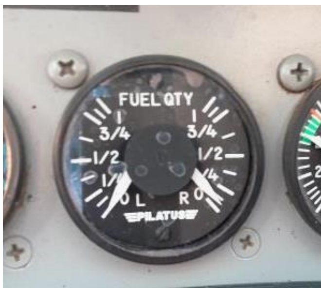
Att. 16. Degvielas rādītāja rādījumi uz gaisa kuģa instrumentu paneļa
