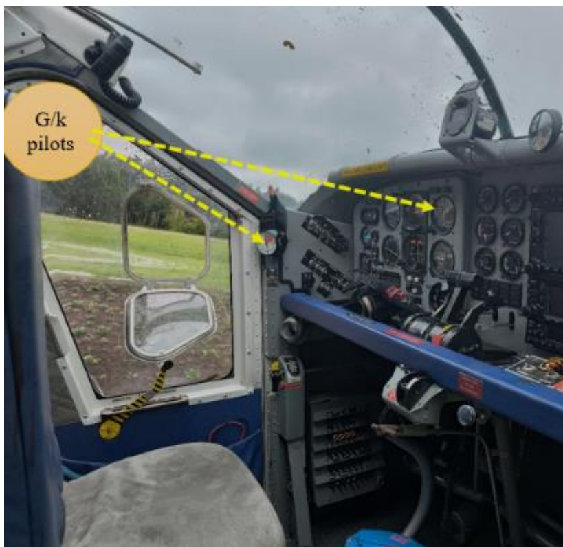
Att. 21. Gaisa kuģa pilota pozīcija attiecībā uz kabīnē izvietotajiem altimetriem
