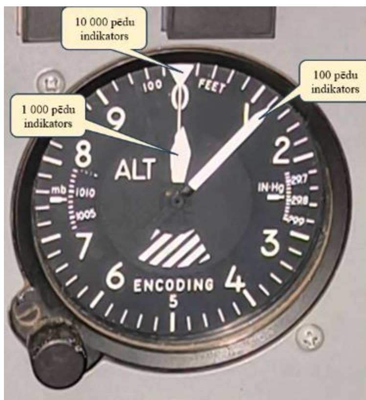
Att. 30. Gaisa kuģa barometriskais augstuma rādītājs
