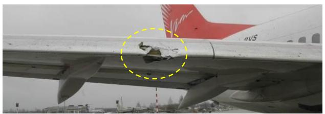
Photo 4 R/H Leading Edge Slat No 5 damages
